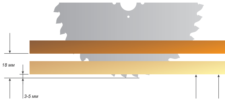
Рис. 6 Надлежащее положение переносной пилы с глубоким резом (источник: Leitz GmbH & Co. KG)
